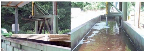
*Figura 10. Trattamento ad immersione di tavole di conifera per uso strutturale con soluzione di sali solubili.*
