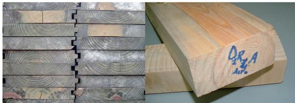
*Figura 9. La penetrazione del preservante è funzione del tipo di trattamento e della specie legnosa. Il durame di molte specie è impermeabile anche con trattamenti a pressione (assortimenti di pino impregnati a pressione con sali solubili).*
