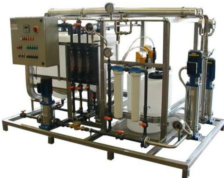
In questo metodo vengono utilizzati dei filtri formati da particolari membrane adatte alla filtrazione; queste permettono di separare delle sostanze micromolecolari di dimensioni inferiori a  $0,001 \mu\text{m}$ .
